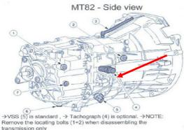
IMAGE LEFT SHOWS POSITION TO INSTALL 9954-256 SENSOR. SUITABLE POWER AND GROUND CONNECTIONS CAN BE TAKEN FROM THE VEHICLE FUSEBOX.
